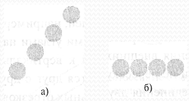
Рис. 5. Штрихи разной длины, которые изображаются с помощью одинакового количества пикселей
