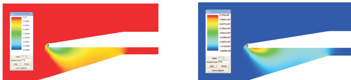
Рис. 1: Распределения концентраций кислорода O_2 (слева) и ионов NO^+ (справа) на входе в канал диффузора
