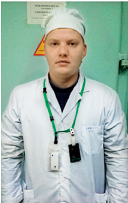
Рис. 2 Расположение дозиметров D-Shuttle и Harshaw 6600 на теле работника во время облучения
