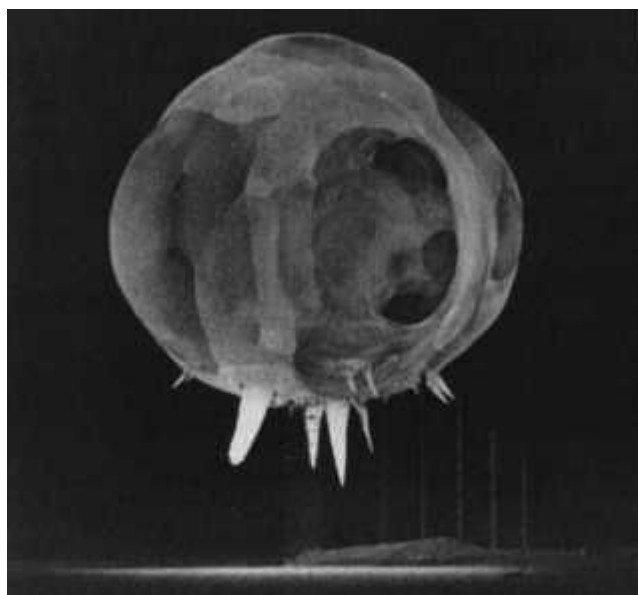
Рис. 36. Вид облака взрыва через 1 мс после детонации ядерного заряда, время экспозиции 1 мкс.
