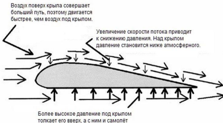
Схематическое изображение подъемной силы крыла самолета
