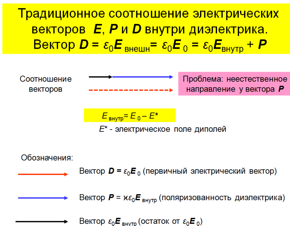
Рис.1. Соотношение электрических векторов в традиционном представлении.
