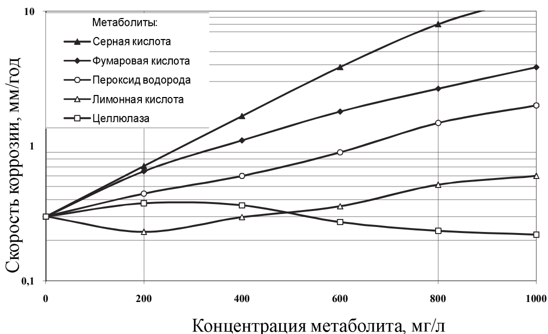
Рис. 6. Изменение скорости коррозии стали Ст.20 при 20°C в воде в зависимости от содержания в ней некоторых продуктов жизнедеятельности микроорганизмов
