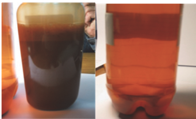
Рис. 11. Фотография хладоносителя до регенерации (а) и после регенерации (б)
