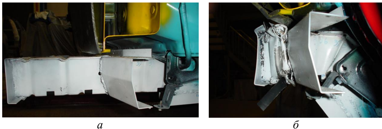
Рис. 1. Потеря устойчивости лонжерона кузова автомобиля: а – лонжерон до столкновения; б – лонжерон после столкновения
