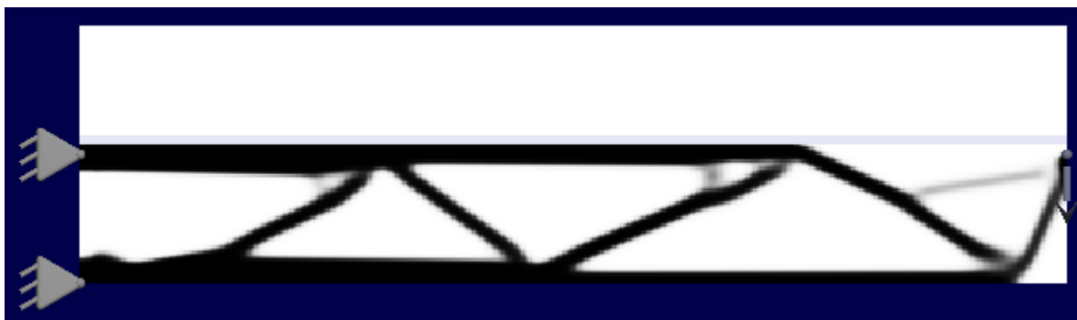
Рис. 4. Исключение части рабочей области из области построения
