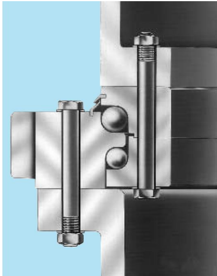
Рис. 7. Крепление опорно-поворотного круга
