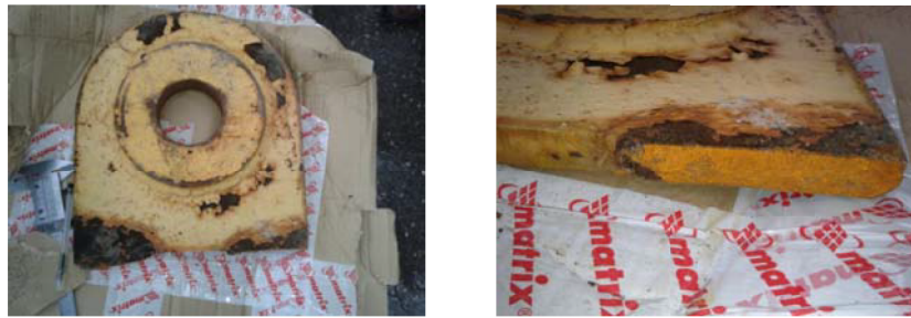
Рисунок 2 - Проушина после разрушения
