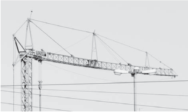
Рис. 3. Стрела башенного крана с системой оттяжек и стоек
