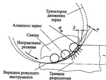
Рис. 2. Схема для расчета толщины срезаемого слоя единичным зерном при шлифовании
