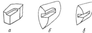
Рис. 2.5. Пазы под пайку твердосплавных пластинок: а - открытый, б - полузакрытый, в - закрытый
