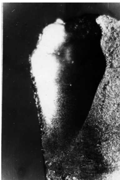
Рис.2.10. Влияние профиля режущей кромки на форму лунки: СЧ25 - ВК6; резец - ВА3, квадратная пластина с задним углом, \phi=75^\circ ; V=1,3\text{ м/с} ; t=2\text{ мм} ; S=0,5\text{ мм/об}
