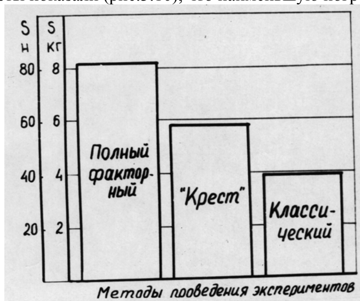
Рис.3.10. Влияние метода проведения экспериментов на среднеквадратическое отклонение расчетных значений силы резания от экспериментальных
