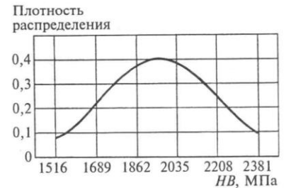
Рис. 1. Кривая плотности распределения твердости обрабатываемого материала
