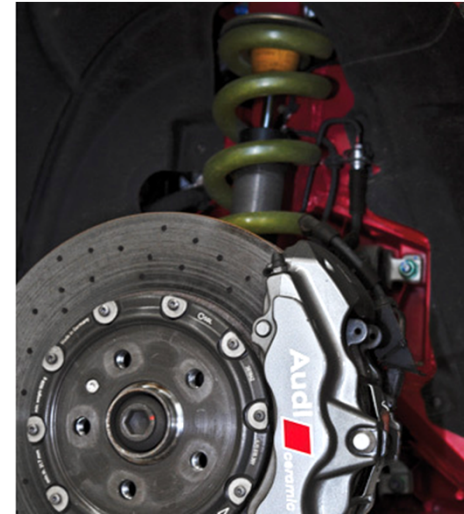
Стеклопластиковые пружины на серийном автомобиле Audi купе R8
