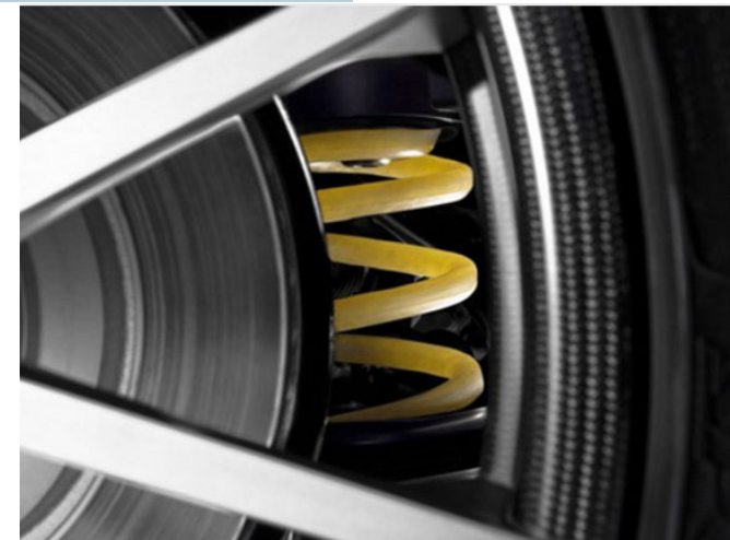
Стеклопластиковые пружины на серийном автомобиле Audi купе R8
