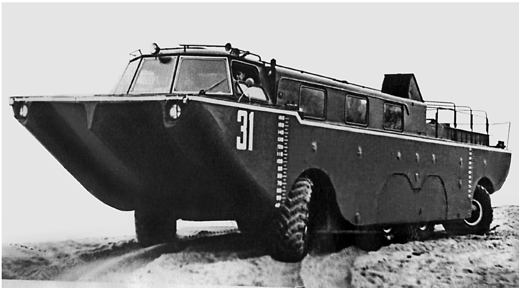
Плавающая десантно-транспортная машина с несущим цельнопластмассовым кузовом
