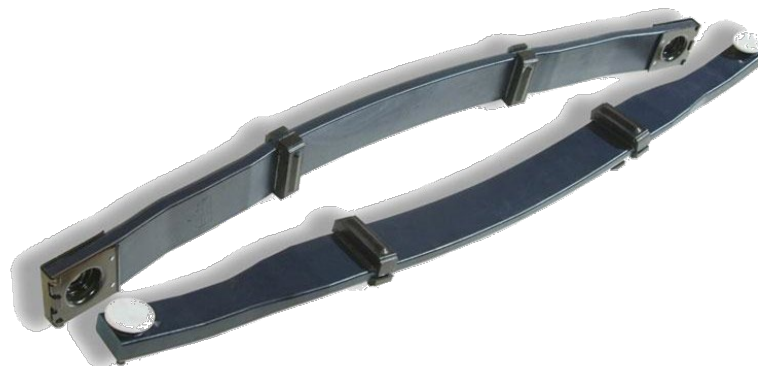
Задняя подвеска Chevrolet Corvette модели 1998 года
