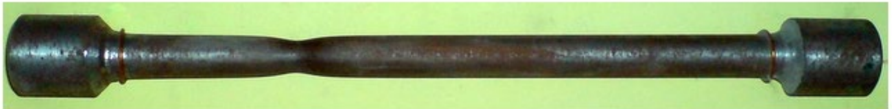
Рис. 2 Стальной образец с "шейкой"
