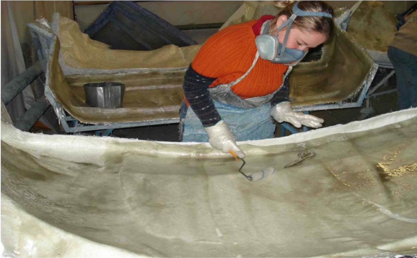
Фотография рабочего места при формовании изделий из ПКМ методом ручной укладки.
