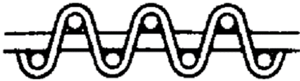
Однослой- ная трехнаправленная (3D) ткань
