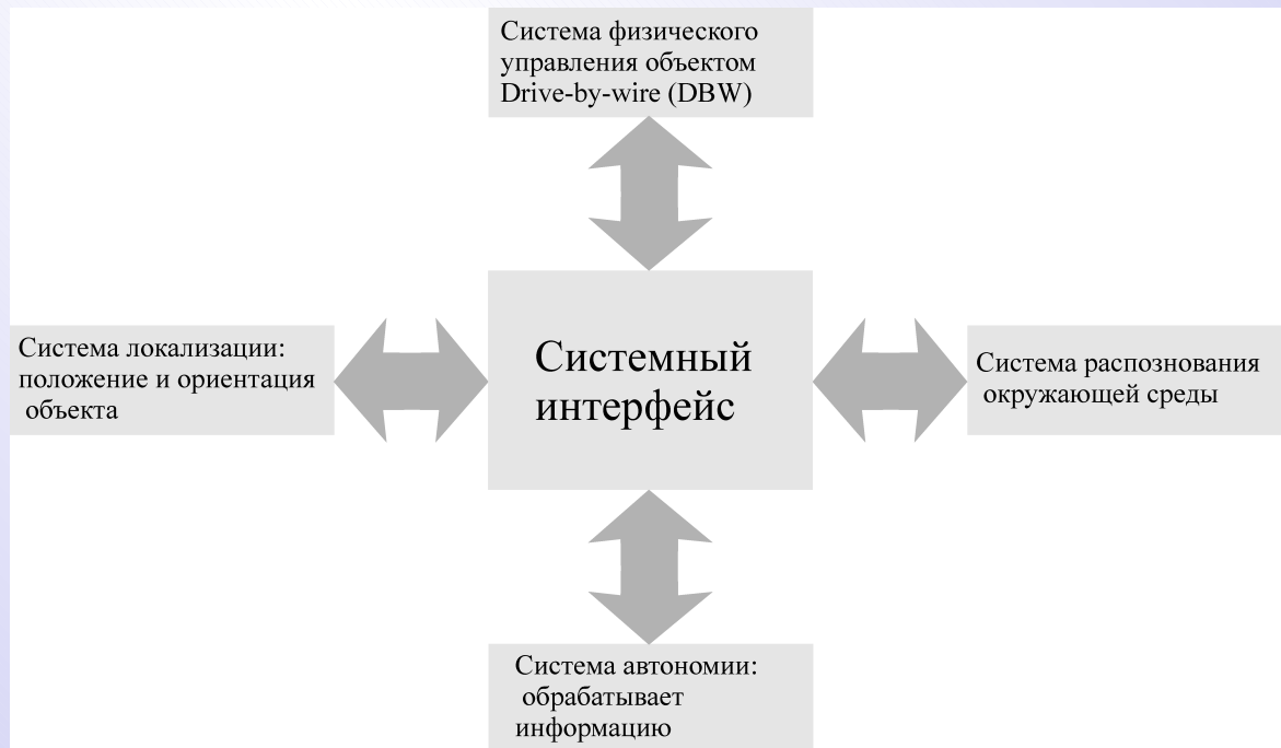
Рис. 1. Обобщенный пример гипотетической структуры подсистем для автономного транспортного средства
