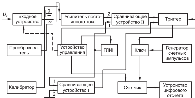
Рис. 7.24. Функциональная схема электронного цифрового вольтметра с время-импульсным преобразованием
