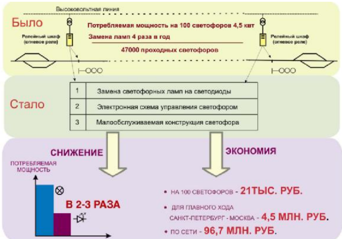
Рис. 7. Технико-экономическая эффективность внедрения светодиодных систем для сигнализации
