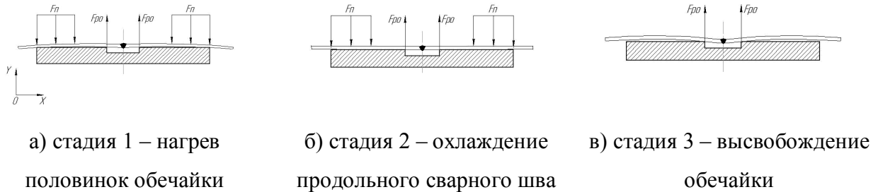
Рисунок 4.22. Схемы закрепления половинок обечайки в процессе сварки и охлаждения
