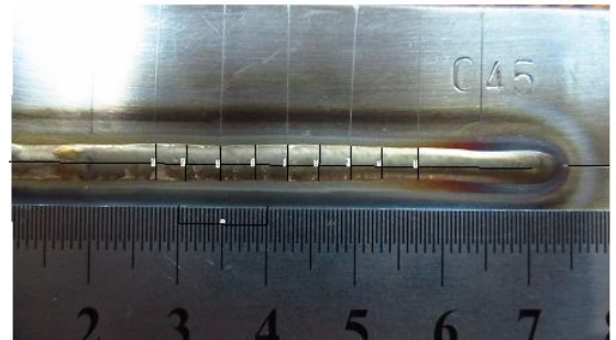
г) Режим сварки: I_{св}=115A , V_{св}=15M/ч , l_{МП}=3 мм
