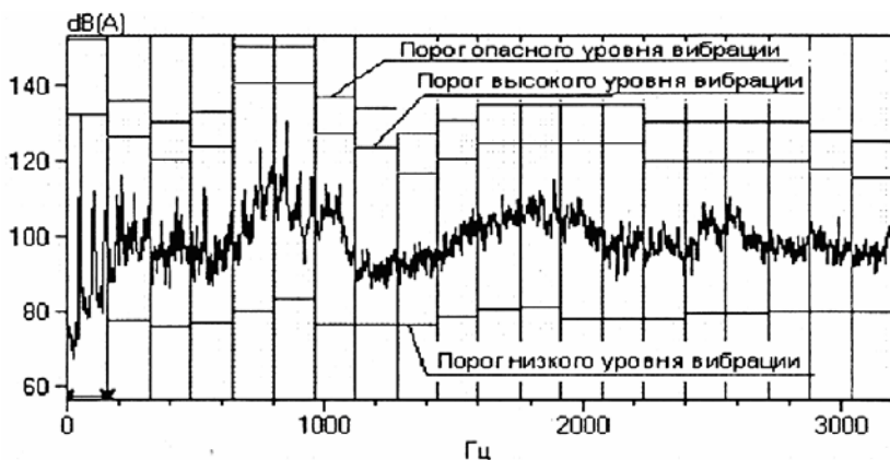
Рис. 9 – Узкополосный спектр вибрации редуктора
