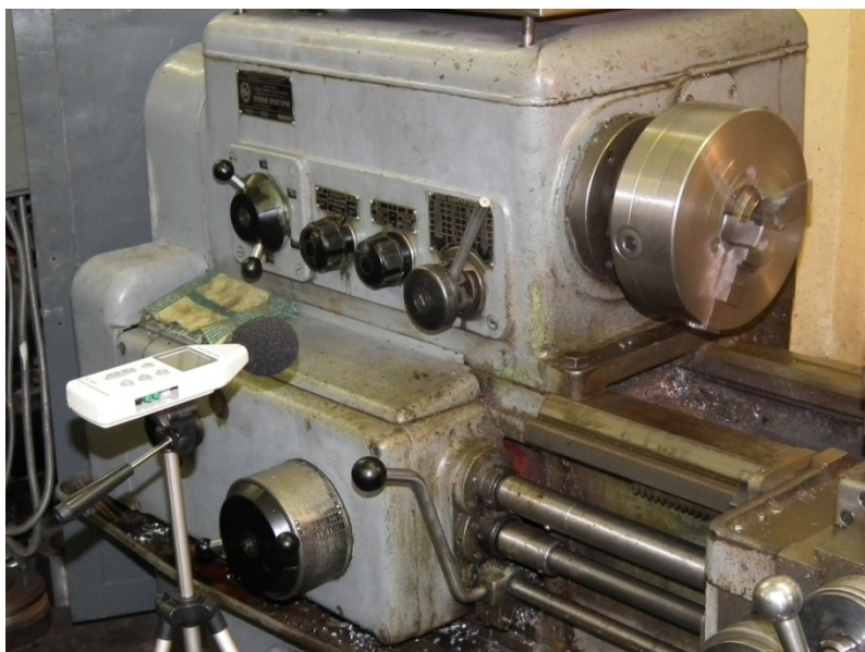
Рис.2 Измерение уровня шума
