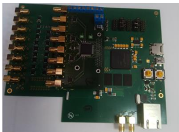
Рис. 6. 16-канальный модуль регистрации в составе с дополнительным модулем регистрации постоянной составляющей
