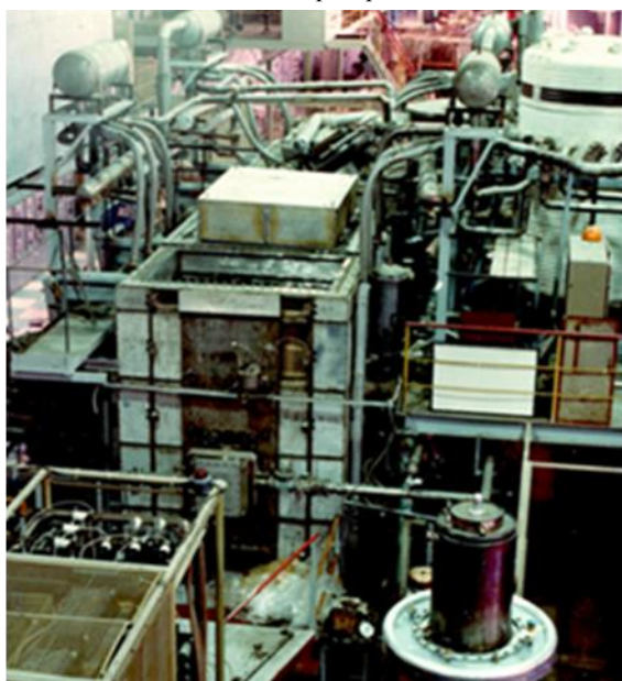
Инжекторный стенд ИРЕК для отработки ионных источников для инжекторов Т-15
