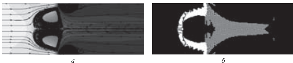
Рис. 2. Поле температуры и линии тока течения (а), область формирования частиц анатазной модификации (б). Темный цвет соответствует более низкой температуре и более низкой концентрации возникающих частиц
