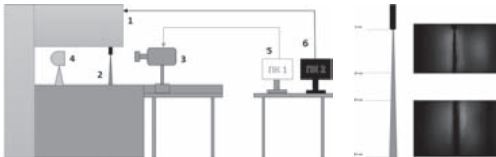
Рис. 1. Слева показана схема эксперимента. Обозначения: 1 — установка Flow WaterJet Mach3; 2 — струя; 3 — высокоскоростная камера; 4 — зондирующая лампа 500 Вт; 5 — ПК 1, отвечающий за управление камерой; 6 — ПК 2, отвечающий за управление установкой. На рисунке справа показана верхняя и нижняя области съемки
