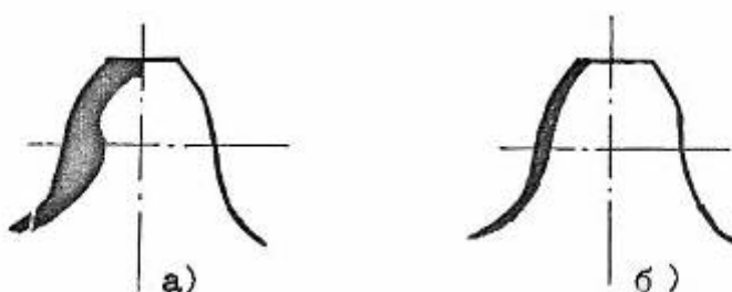
Рис. 1.3. Характер износа зубьев шестерён в вакууме [3]:
