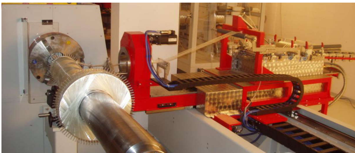
Рис. 2.2. Система штифтов на торцах оправки для зацепления нитей при смене направления движения каретки для обеспечения непрерывности намотки (фотография из буклета выставки MIKROSAM 2009 г.)
