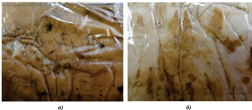
Рисунок 2. Воздействие на липкий слой из синтетического каучука «Hot Melt» на полимерном покровном слое: а) после растворителя «Нейтрализатор» («Стикер», Россия) и б) уайт-спирита «Ясхим» (Россия).
