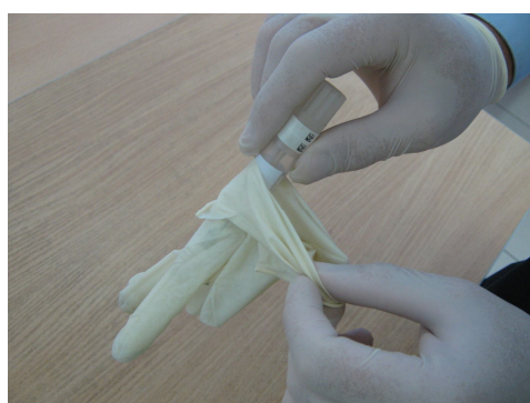
Рис. 2. Способ введения цилиндрического предмета диаметром 17 мм в пальцевый карман перчатки
