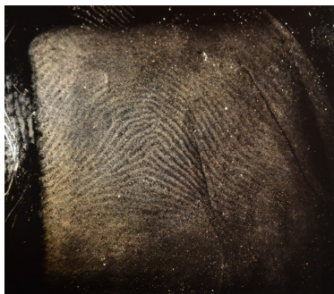
Рис. 4. След указательного пальца правой руки, перекопированный с изнаночной поверхности на отрезок дактилоскопической темной пленки размером 40х60 мм, зафиксированный методом светопольного освещения
