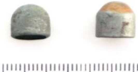
Рис. 2. Пули патрона 9x18 мм (ПМ) после снятия окалины
