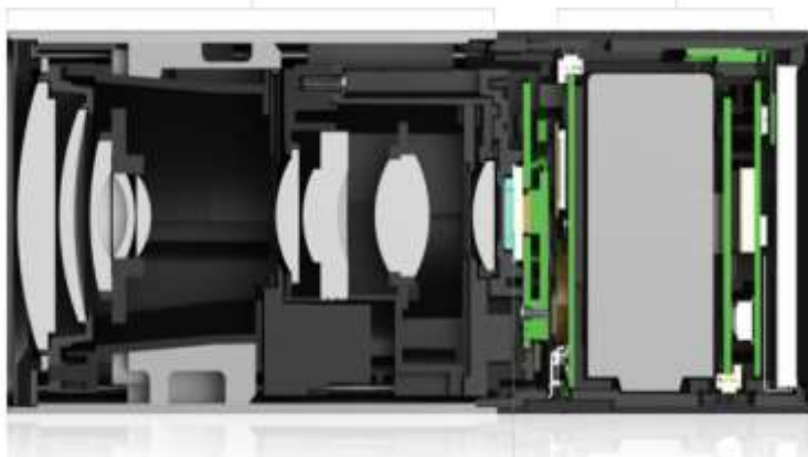
Рис. 4. Устройство камеры «Lytro»
