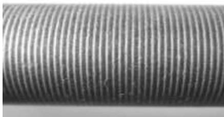
Рис. 1. Следы, образованные токарным резцом, на поверхности ствола самодельного однозарядного пистолета
