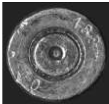
Рис. 3. Дно гильзы, стреляной в пистолете ГШ-18 со следами оружия
