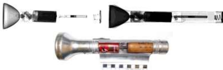
Ил. 2. Самодельное взрывное устройство типа мина-ловушка, с различными режимами съемки рентгеновским просвечивающим комплексом КРП-01 «Сатурн»
