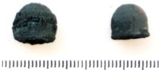
Рис. 1. Пули пистолетного патрона 9x18 мм (ПМ), подвергавшиеся воздействию температуры 1000 °С в течение 30 мин
