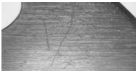
Рис. 5. Следы, образованные плоскошлифовальным станком, на поверхности курка самодельного пистолета
