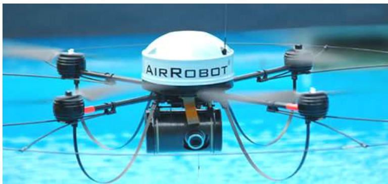
Рис. 2. БПЛА Микадо с закрепленной на него видеокамерой
