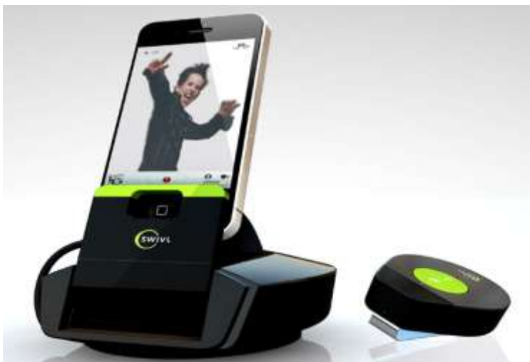
Рис. 1. Держатель с электромотором, в который вставлен телефон. Рядом расположен электронный маркер с креплением для одежды
