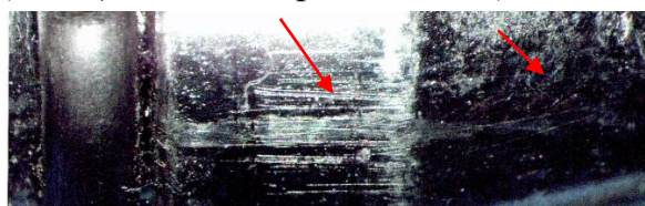
Рис. 7. Фрагмент стержня с двух сторон с первичными следами (показаны красителем красного цвета) от фигурной цанги
