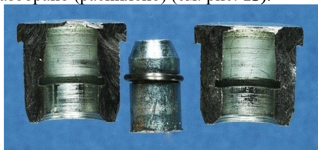
Рис. 13. Запирающий механизм ЗПУ, после разборки
