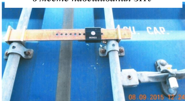
Рис. 8. Фрагмент контейнера в месте навешивания ЗПУ
