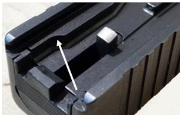
Рис. 8. Скос выступа на нижней плоскости затвора
