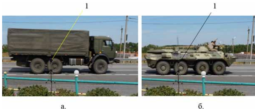
Рис. 6. Видеофиксация экспериментальных проездов транспортных средств: 1 – видеокамера, установленная перпендикулярно направлению движения транспортных средств.
