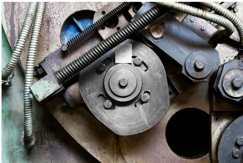
Рис. 2. Исследуемый кулачковый механизм и эталон длины
